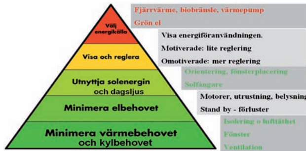
Figur 4.1 Kyotopyramid för projektering av lågenergihus, där man börjar från botten och går uppåt. Pyramidens kompletterad jämfört med förlagan (Dokka, 2006).
